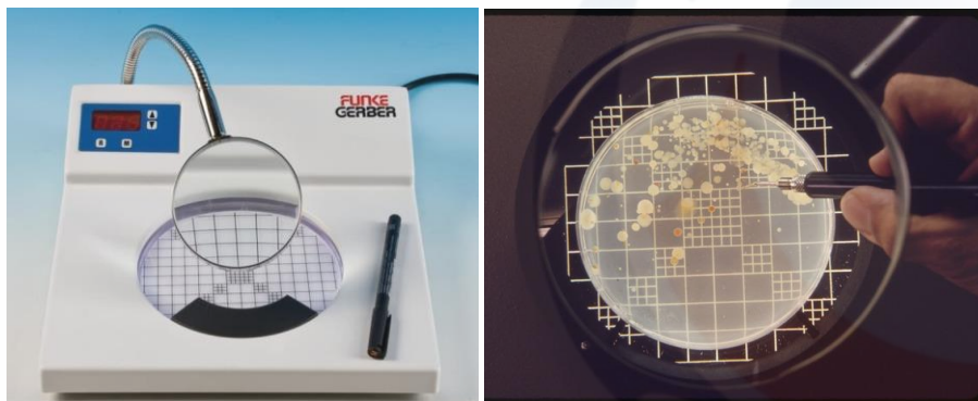
Gambar 11. Alat colony counter (kiri) dan cara menggunakannya (kanan).
